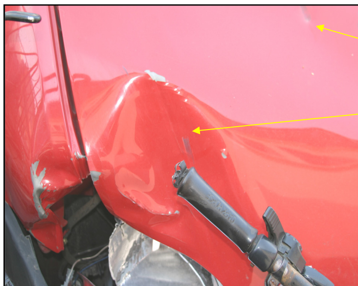
Fig. 4. Urme create pe frontala autovehiculului în urma impactului
