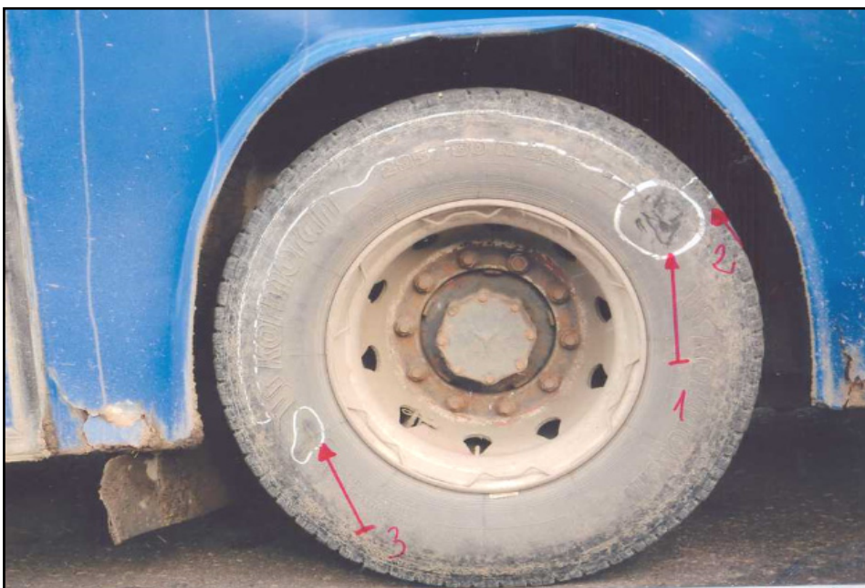
Fig. 9. Urme de destratificare - ștergere imprimate pe anvelopa dreapta spate a autovehiculului.
