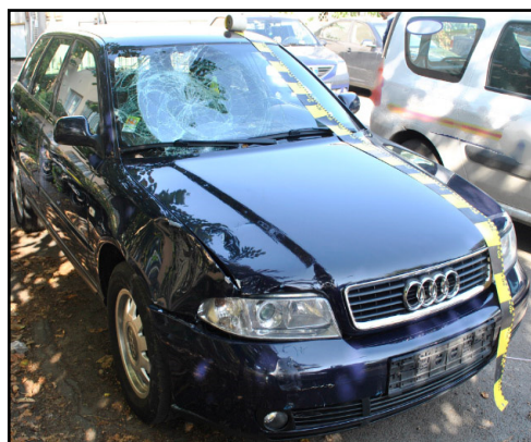
Fig. 12. Aspectul frontalei unui autoturism după impactul cu un biciclist poziționat perpendicular pe traiectoria autoturismului
