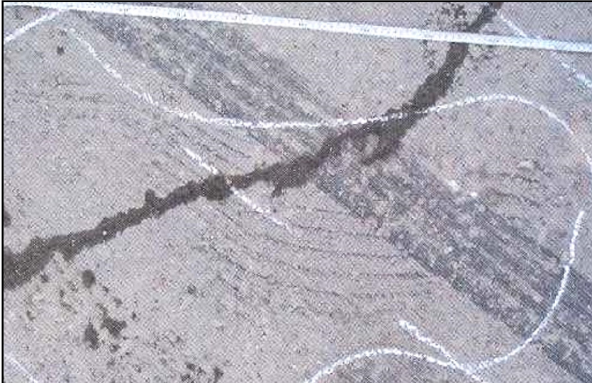
Fig. 10. Urmă imprimată de pneul bicicletei în momentul impactului
